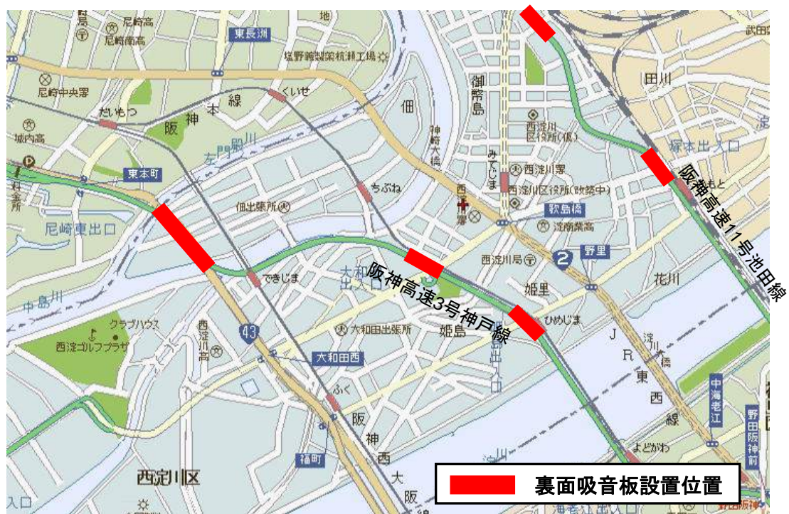
高架裏面吸音板の設置位置図
